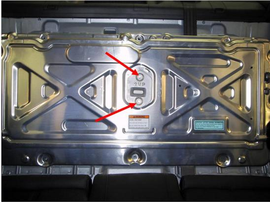
2. Die zwei Schrauben der Abdeckung des Batterie Hauptschalters mit einem 10 mm-Schlüssel oder einer Zange entfernen und die Abdeckung abnehmen.
