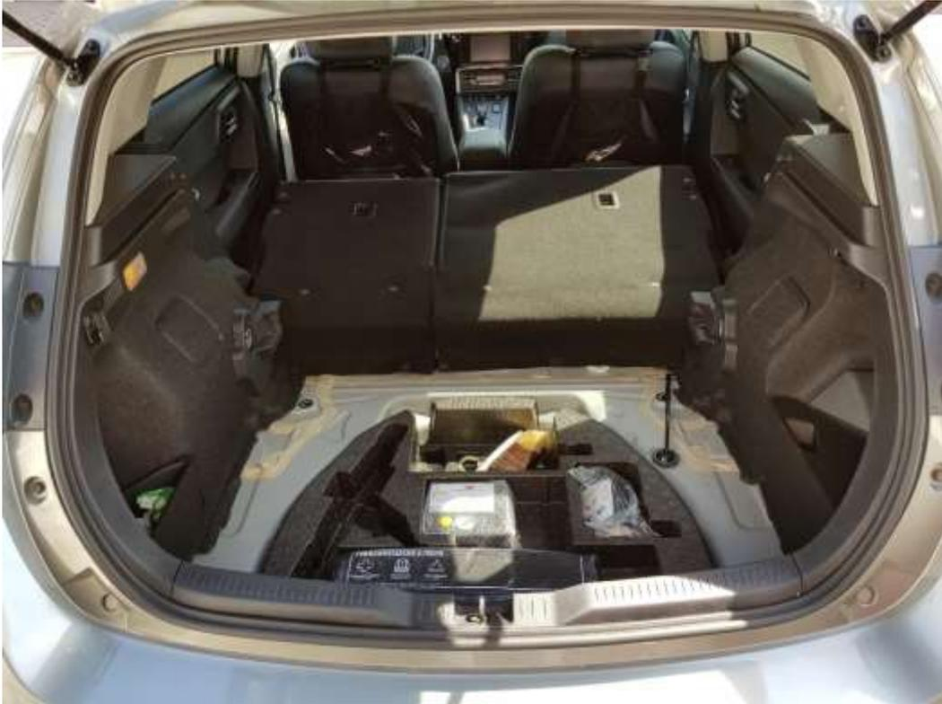
2. Styroporform aus der Rad-Mulde abmontieren.
