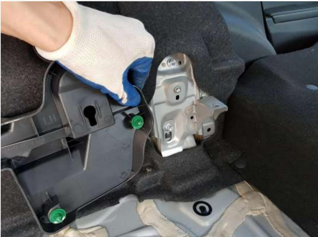
5. Plastikabdeckung an den Seiten abziehen. Von unten (hinten) anfangend die Clips einzeln ablösen.
