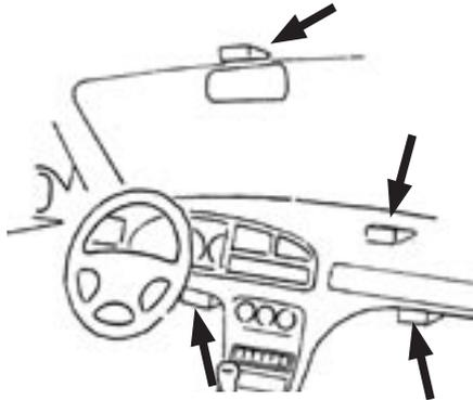
**Achten Sie darauf, daß das Display nicht im Kopfaufschlagsbereich bzw. auf oder neben einem Airbag montiert wird.
