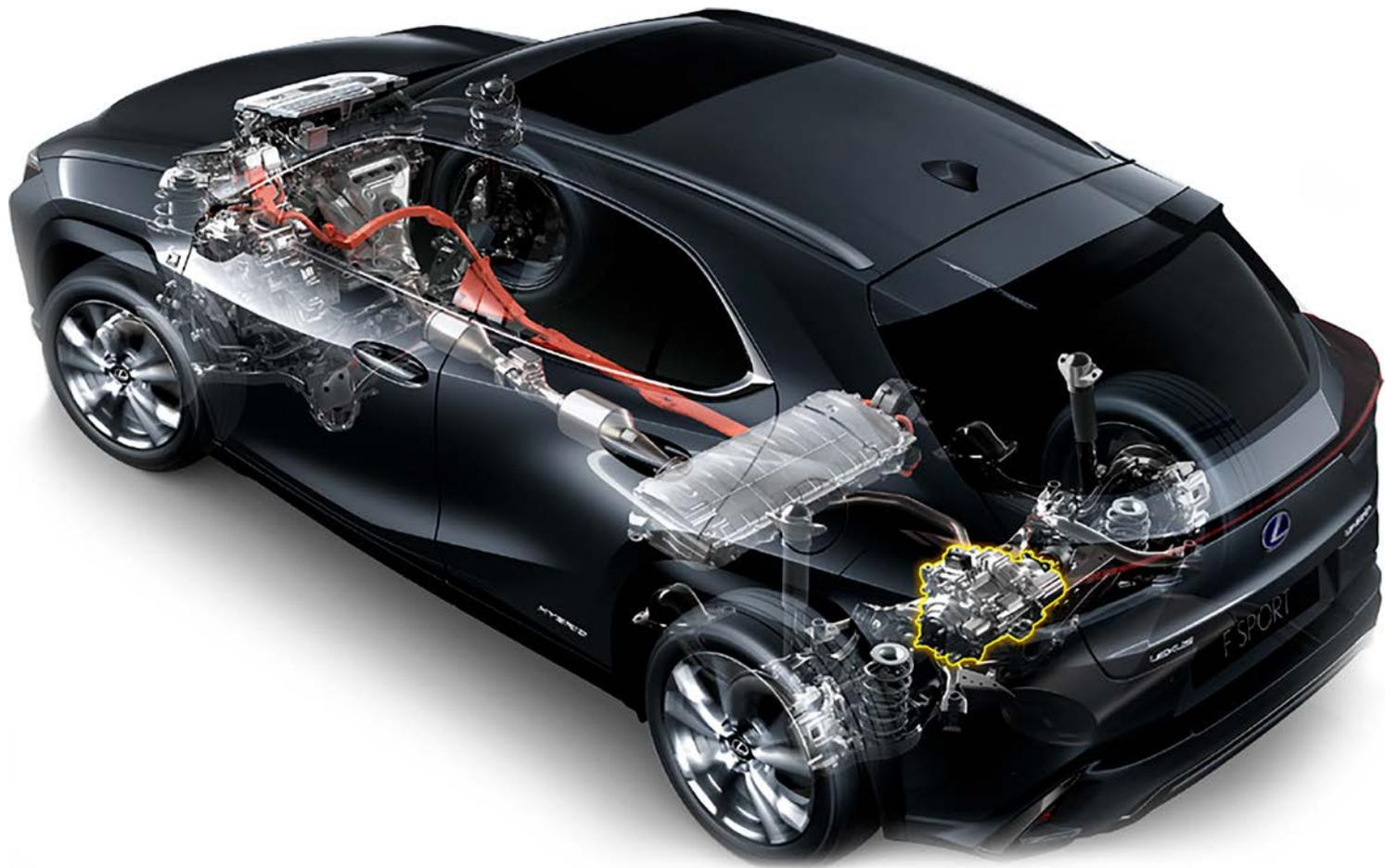
Im neuen Transaxle-Getriebe sind die beiden Elektromotoren MG1 und MG2 nicht linear, sondern koaxial gekoppelt. Dadurch werden die Reibungsverluste in dem kleineren und leichteren Gehäuse um 25 Prozent reduziert. Darüber hinaus dreht der Antriebs Elektromotor MG2 nun mit höheren Drehzahlen und ist noch leistungsstärker sowie effizienter als bisher. Der Fahrer profitiert dadurch von einem niedrigeren - und klassenbesten - Wendekreis von 10,4 m und ist entsprechend einfach zu manövrieren.
