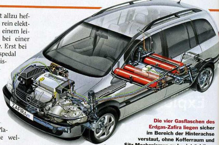
**Die vier Gasflaschen des Erdgas-Zafira liegen sicher im Bereich der Hinterachse verstaut, ohne Kofferraum und Sitz-Mechanismus zu beeinträchtigen**
