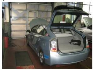
Das Laden geht einfach: Stecker in die Steckdose, Klappe am Auto auf, Deckel entriegeln, einstecken, dann am Testgerät im Kabel auf <TEST> drücken, wenn keine Fehlermeldung kommt (soll z.B. bei Leckstrom warnen), auf <RESET> drücken und der Ladevorgang beginnt.
