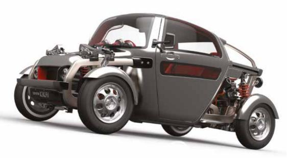
TECHNIK UND MECHANIK, DIE NORMALERWEISE UNTER DEM BLECHKLEID EINES FAHRZEUGS VERBORGEN IST, STELLT DAS KIKAI CONCEPT OFFEN ZUR SCHAU
