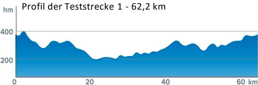
Landstraße mit kleineren Ortschaften und einem Geschwindigkeitsbereich zwischen 30 und 70 km/h - 95 % mit ACC gefahren. Geringe Verkehrsdichte - Durchschnittsgeschwindigkeit 41 - 43 km/h
