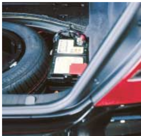
Batterie im Heck: Ein nicht abgeschirmtes Kabel unter dem Fahrgastraum (Zeichnung rechts: Volvo) führt bei den meisten Fahrzeugen zu hohen Strahlungswerten
