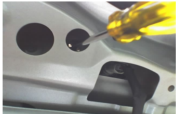
Abbildung 4: Demontage Heckklappen - Griff
