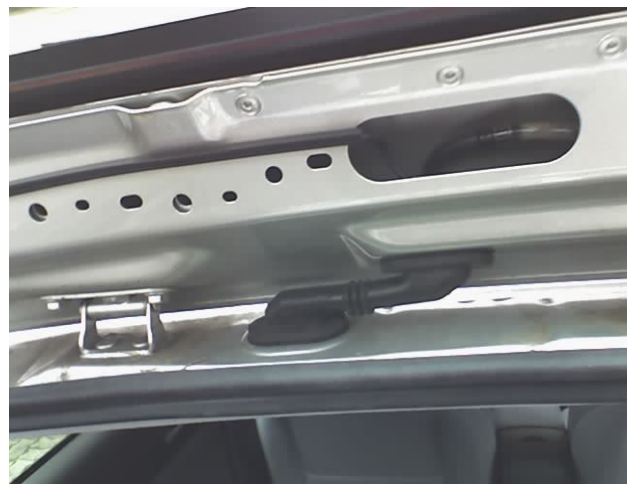
Abbildung 12: Lage der Kabelkanäle
