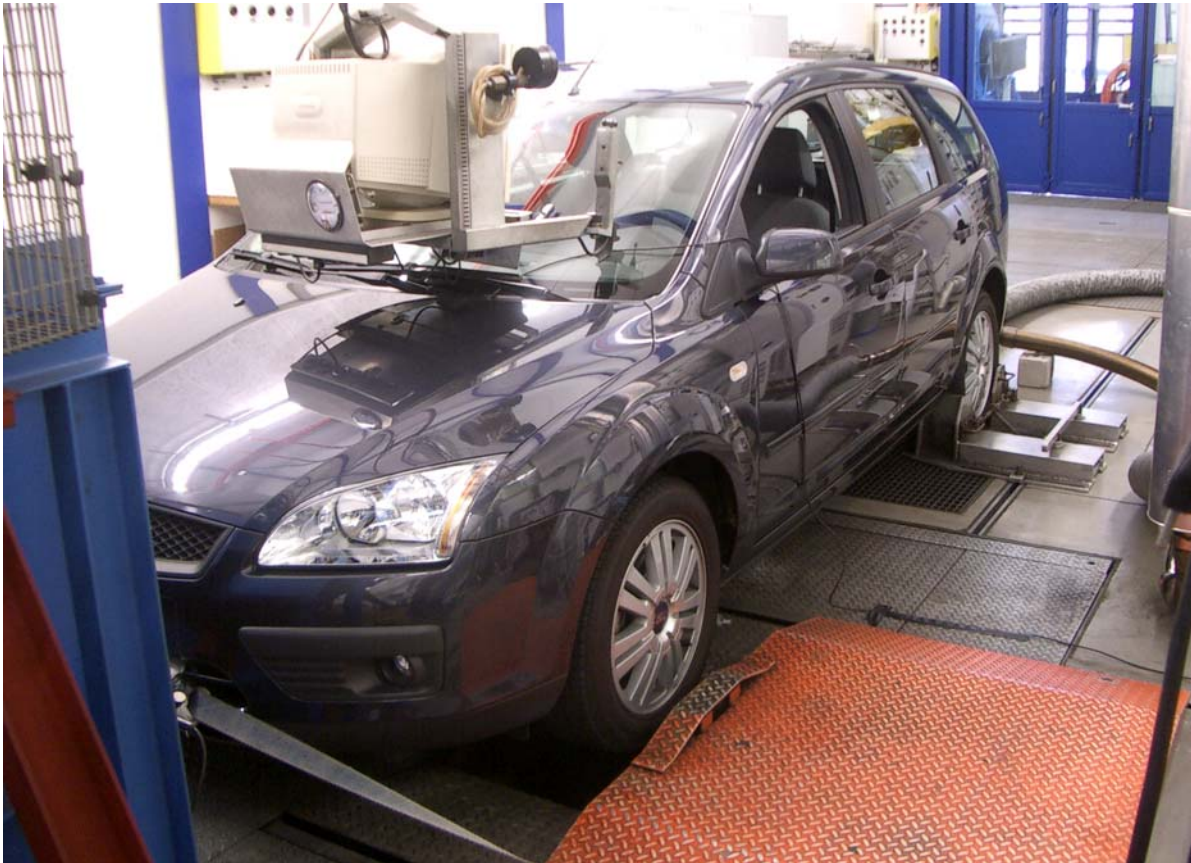
Abbildung 1 Versuchsfahrzeug auf Einrollenprüfstand aufgebaut
