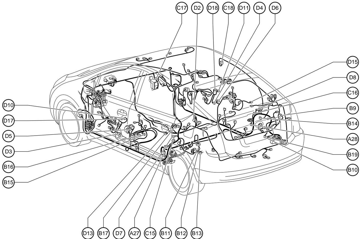
A27 ABS-Raddrehzahlsensor, hinten, links
